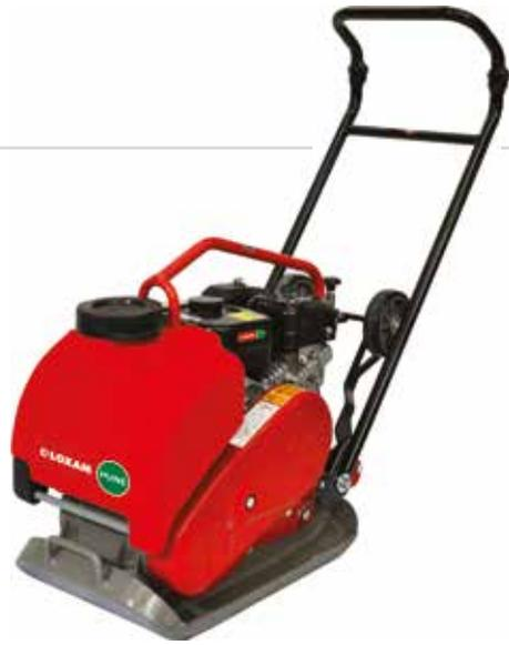
Máquinas excelentes para el compactado de suelos con revestimiento y adoquinado: obras de carretera, paisajistas, colocación de adoquines, compactado a lo largo de suelos y aceras, de zanjas y del fondo de excavación.
